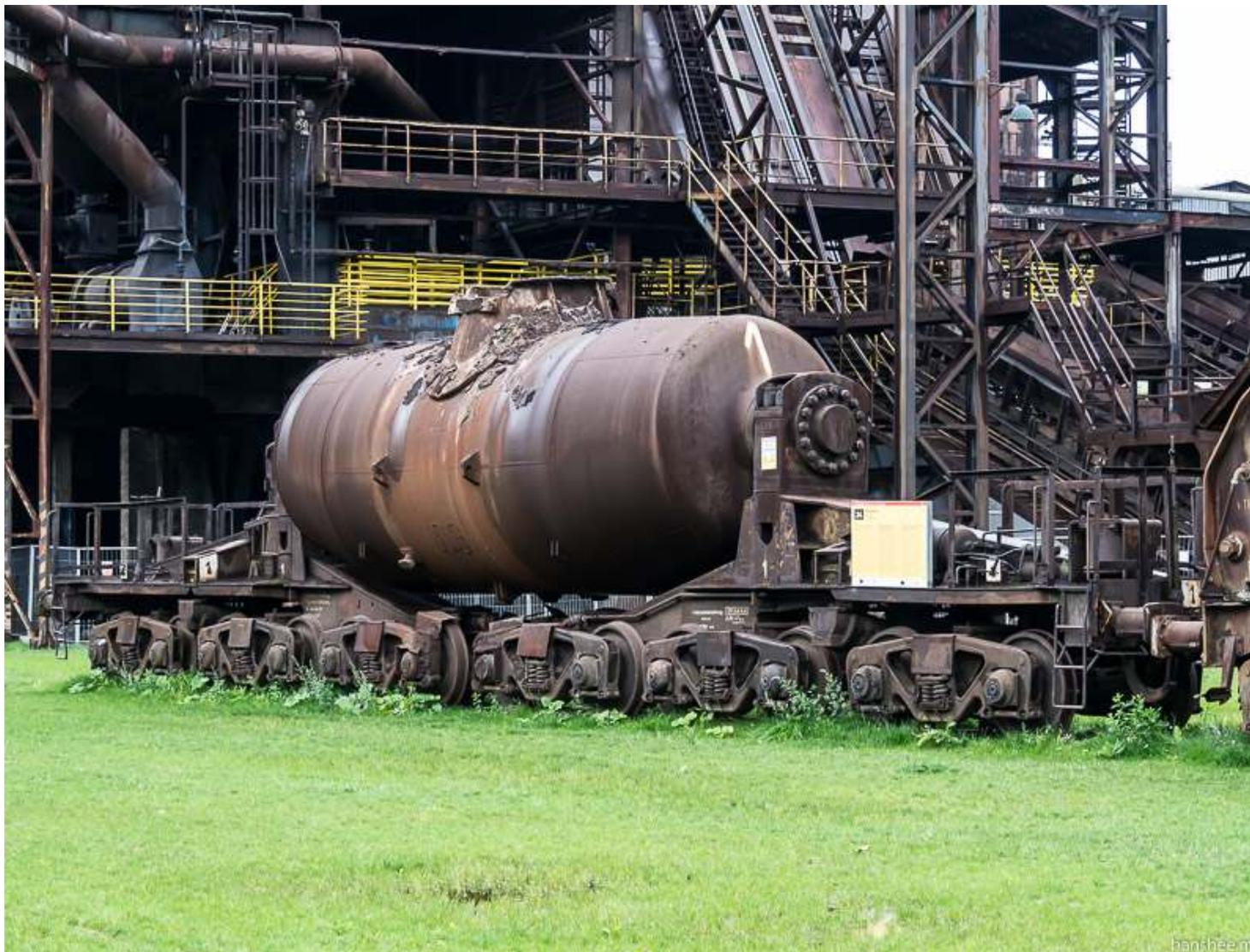
«Сигара» для перевозки жидкого чугуна
