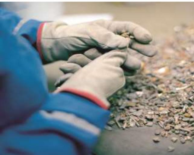
Ручная разборка и удаление опасных компонентов,
