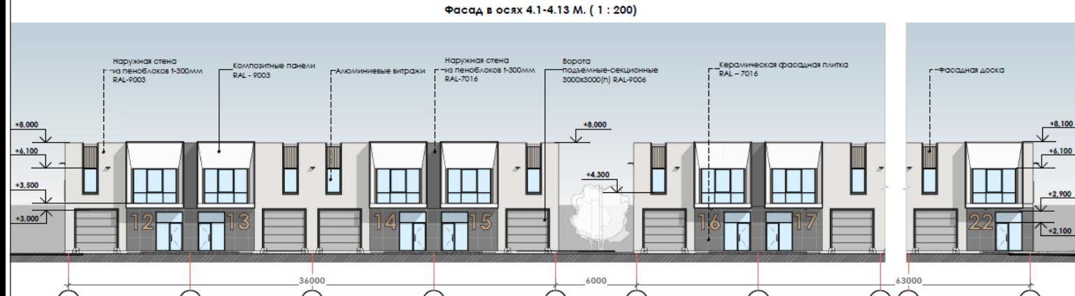
Фасад в осях 4.13-4.1 М. ( 1 : 200)
