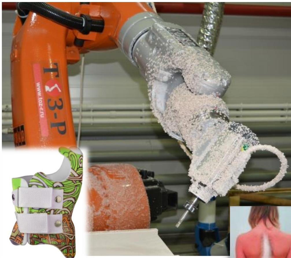
Корсет Шено изготавливается из термопластических материалов методом роботизированной фрезеровки по результатам рентгена и 3D-сканирования тела пациента или индивидуальному гипсовому слепку.
