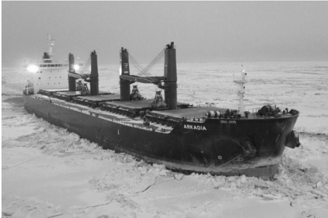
56k Supramax-class 2 x 56 000 dwt Iceclass 1A
